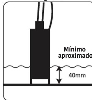
Se houver algum detrito no líquido a ser bombeado, coloque a bomba em uma superfície nivelada e estável, assim evitando sugar quaisquer detritos que poderiam danificar ou bloquear a bomba. Cuidado na posição escolhida para a colocação da fonte de energia da bateria, a mesma deve estar em uma superfície segura, estável e nivelada, longe do líquido que está sendo bombeado.
